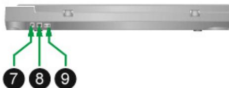
7. 电源连接接口：将电源变压器一头插入此电源连接接口，另一头则插入标准电源插座。
