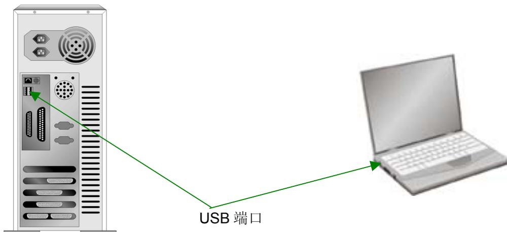
如果您的计算机上找不到这种 USB 端口，您必须购买一块合乎标准的 USB 适配卡，为计算机加装 USB 的功能。
